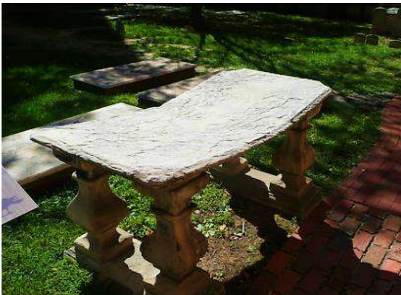
Abb. 6.9-4: Eine sehr alte Marmorplatte auf einem Friedhof in Baltimore als Beispiel für die Plastizität (Duktilität) von Gesteinen.
