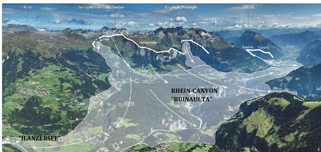
Abb. 6.76: Flimser Bergsturz in Graubünden, Schweiz. Das Bild zeigt die Bergstürze von Kunkels-Tamins, Flims und Bargis in das Vorderrheintal. Zunächst erfolgte der Tamins Bergsturz, kurze Zeit später vor ca. 9490 Jahren der große Flimser Bergsturz und dann der von Bargis. Die dicken weißen Linien sind die Abrisskanten. Damals ist ein bis zu 500 m mächtiges Gesteinspaket, überwiegend aus Kalkstein, in das Vorderrheintal gerutscht und hat eine ca. 11,3 km 3 umfassende, karbonatische und hochverdichtete Trümmermasse aus Pulver, Sand, Steinen und großen Blöcken auf ca. 60 km 2 hinterlassen. Dabei wurde der Vorderrhein zeitweise zum großen „Ilanzersee“ aufgestaut. Heute durchfließt er diese Trümmerlandschaft in einem tiefen Canyon.
