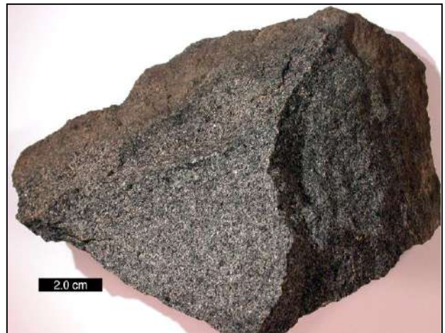
Gabbro: feinkristallines, basisches Gestein, v.a. aus Pyroxen, Olivin, Biotit, Hornblende. Helle Einsprenglinge aus Quarz und Feldspat. SiO 2 -Gehalt < 63 %. Basalt/Gabbro metamorphosieren in 10 – 40 km Tiefe bei 550 – 700 °C zu Amphibolit (Hornblende) und druckdominiert zu Eklogit. Quelle: Wilson44691 ( Mark A. Wilson , gemeinfrei).
